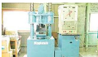
2000kN 耐圧試験機の導入により、超強度コンクリートの試験に対応出来る様備えています。
