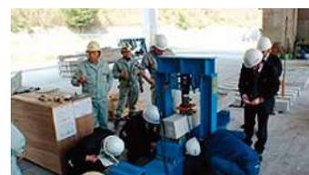
載荷荷重 200kN に対応できる、PC まくらぎ曲げ試験機です。
